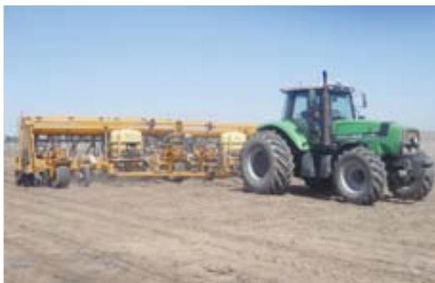
*Sembradora neumática con equipo aplicador de inoculante líquido.*
